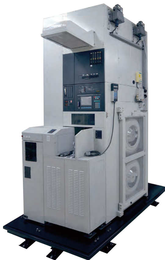
半導体製造装置(拡散炉)
